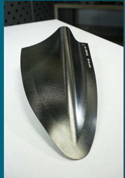
Cette pièce illustre bien l'aisance des composites à produire une géométrie aérodynamique complexe. Elle est fabriquée à partir de résine époxy renforcée à 60 % volumique de fibres de carbone. Il s'agit d'un carénage qui protège des composantes de conduites d'aéronefs.
