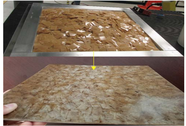
Copeaux bruts de rebuts (haut) et plaque moulée (bas) en PEI/fibre de verre
