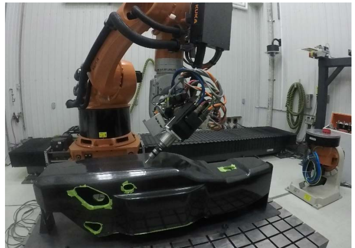
Palpage robotisé d'une pièce complexe en composites
